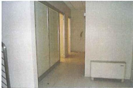
Il riscaldamento, come pure il raffrescamento, viene irradiato all'interno dei locali attraverso termo ventilconvettori (fancoil) posti nei vari locali, ad eccezione per i bagni cui il riscaldamento è irradiato attraverso convenzionali
